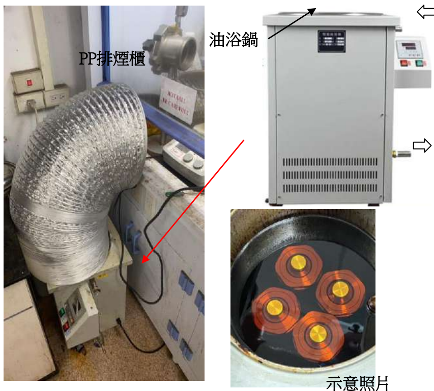
火調小組拼湊爆裂的油浴機（左）與同款油浴機的比對
